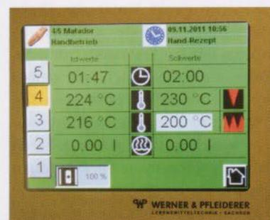
Die Navigo-Touchscreensteuerung kann dank frei programmierbaren Backschritten für jedes Produkt den passenden Temperaturkurvenverlauf speichern.
