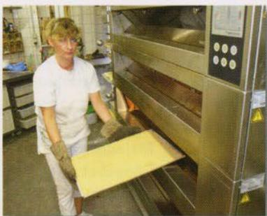
Das 3-Zonen-Heizprinzip des Ofens gewährleistet eine einheitliche Hitzeverteilung. An der dünnen Biskuitroulade ist das gleichmäßige Backergebnis besonders gut erkennbar.
